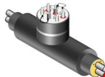
Válvulas con unidades de ventilación/drenaje 4.4.2.
